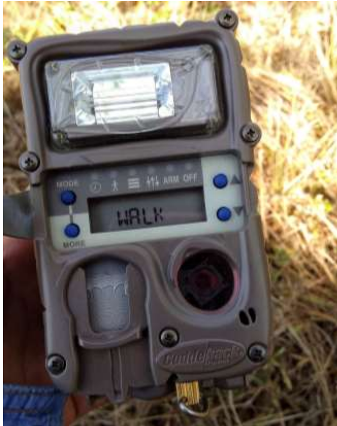
Figura 5. Cámaras trampa utilizadas en el muestreo, marca Cuddeback, con sistema pasivo.
